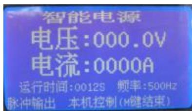
左图为运行屏。第二行为智能电源实际输出电压值。第三行为智能电源实际输出电流值。第四行为设定的运行时间和频率。第五行显示的是智能电源的实时工作状态。在运行屏，按下“M”键，智能电源结束运行，断开主接触器，主电路断电，并返回初始屏。
