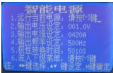
1、按“◀”和“▶”键选择要设定位(光标在可设定位正下方)，按“▲”和“▼”键设定目标值。所有设定值是保存的，开机后为上次设定值。除了光标在第一、六菜单项行尾，否则按下“M”键，光标都跳到第一菜单项行尾。
